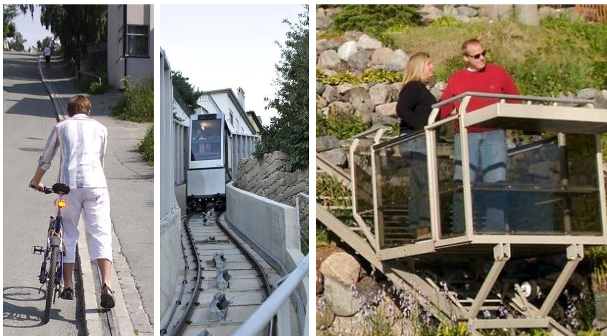
Figura 60. Exemplos de meios mecânicos de auxílio à locomoção ciclável e pedonal, Cyclocable (Trondheim), funicular de São João de Malta (Covilhã) e Hill Hiker (EUA)
