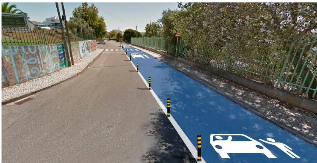
Figura 94. Proposta de implementação de canal Kiss&Ride para a cidade das Caldas da Rainha
